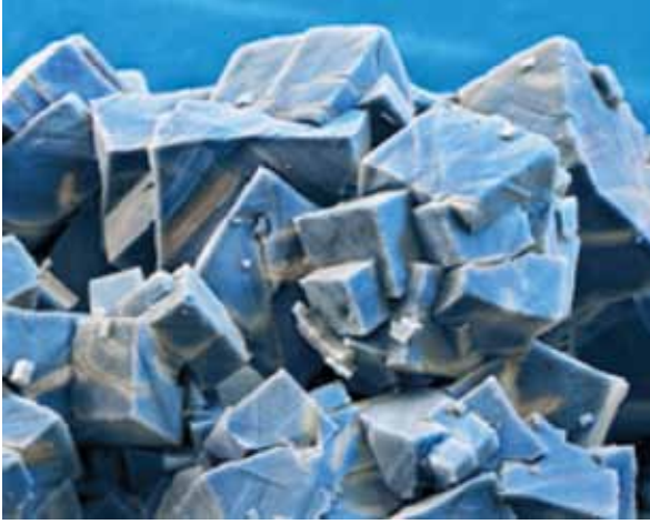
Şekil 5/ Figure 5: BASF tarafından geliştirilen nanoküp formundaki metal organik hibrit malzeme Metal organic hybrid material in the form of nano cube developed by the BASF
