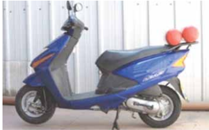
Şekil 4/Figure 4: ANG'li motosikuter/A motor scooter with ANG
