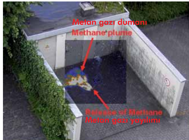
Şekil 2-6: Metan gazı dumanının ölçümü.
